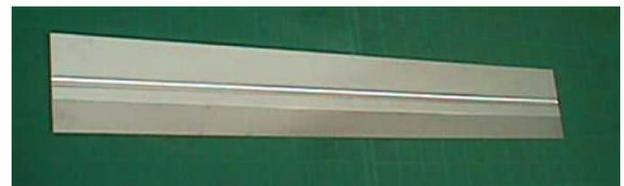
図11 圧接された継手（A1050／SPCC，シーム溶接長さ：1m）
