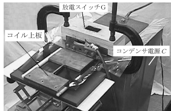
Fig. 4 放電回路部分の外観例
